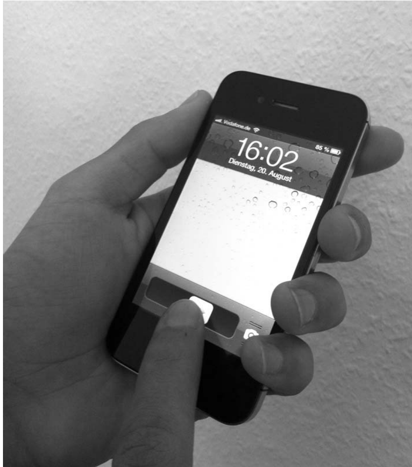
Abb. 8: „Slide to unlock“: Beim iPhone wird durch das Wischen mit dem Finger über den Start-Bildschirm / Lockscreen das Gerät aus dem Bereitschaftsmodus aktiviert
